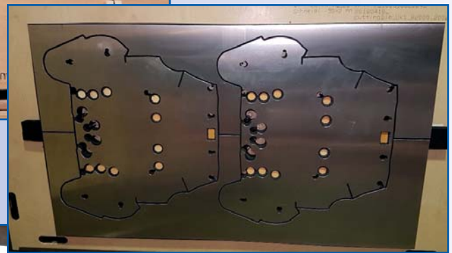
Sonderformen in gefräster und erodierter Ausführung
